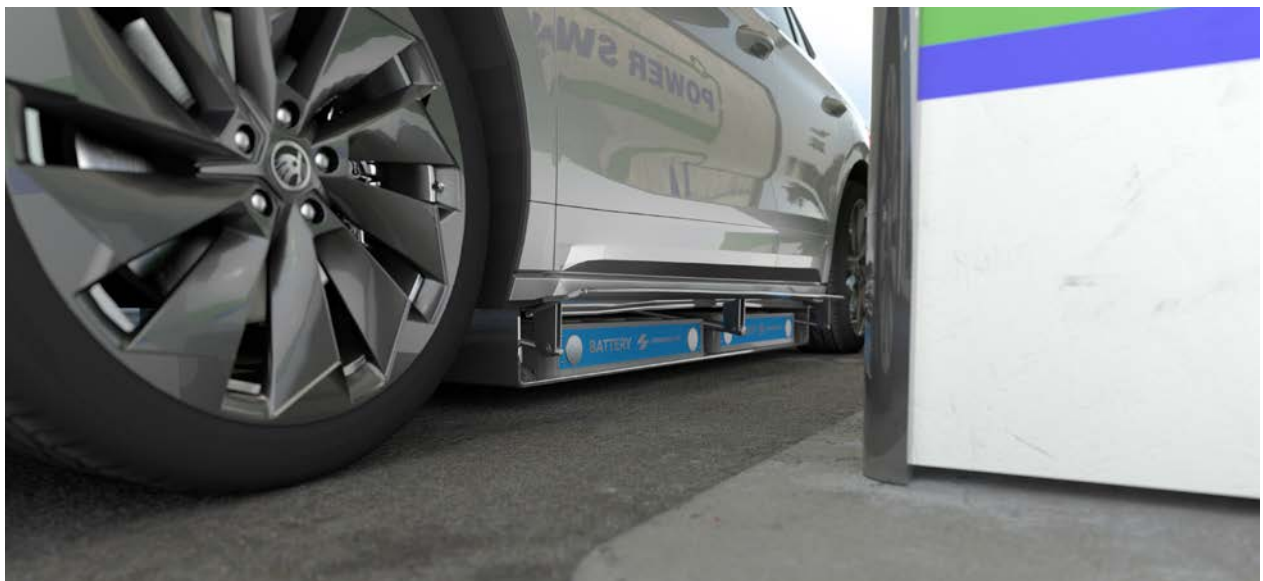
Power Swap-kompatibel bil som initierar byte av batterier. Kassetten sänks ner innan bytet görs.
